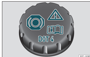
εικ. 190 Χώρος κινητήρα: τάπα δοχείου υγρού φρένων.
