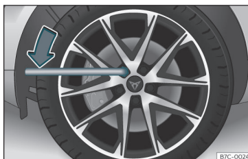
εικ. 37 Αλλαγή τροχού: λασκάρετε τα παξιμάδια του τροχού.
