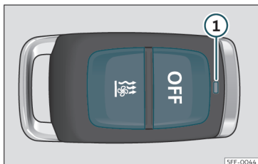
εικ. 125 Βοηθητική θέρμανση: τηλεχειριστήριο ραδιοκυμάτων.
