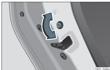
εικ. 76 Κλειδαριά ασφαλείας για τα παιδιά στην πόρτα της αριστερής πλευράς.
