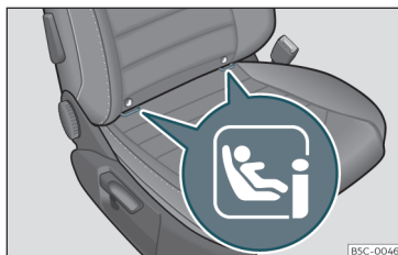
εικ. 28 Κάθισμα συνοδηγού: Δακτύλιοι ασφάλισης ISOFIX/i-Size.
