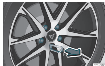
εικ. 35 Τροχός: παξιμάδια τροχού με καπάκια.
