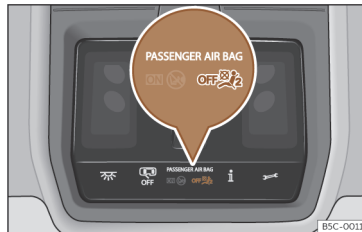
Εικ. 30 Στην κονσόλα της οροφής: λυχνία ελέγχου απενεργοποίησης του αερόσακου του συνοδηγού.
