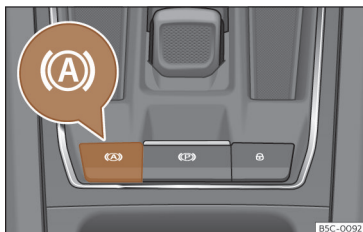
Εικ. 146 Στο κάτω μέρος της κεντρικής κονσόλας: Μπουτόν λειτουργίας Auto Hold (Αυτόματης Συγκράτησης).
