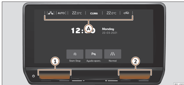
Εικ. 108 Σχηματική αναπαράσταση: λειτουργίες κλιματισμού.
