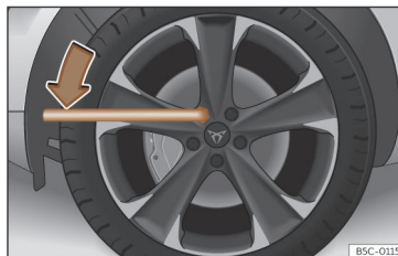
Εικ. 235 Αλλαγή ελαστικού: λασκάρετε τα μπουλόνια του τροχού.
