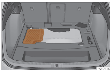
Εικ. 225 Υβριδικά οχήματα (PHEV): θέση της μπαταρίας μέσα στον χώρο αποσκευών
