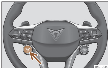
Εικ. 117 Τιμόνι πολλαπλών λειτουργιών: μπουτόν για την αλλαγή του προφίλ οδήγησης.
