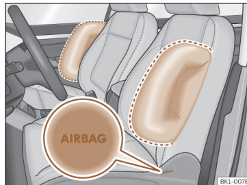
Εικ. 33 Πλευρικοί αερόσακοι καθίσματος οδηγού και καθίσματος συνοδηγού.
