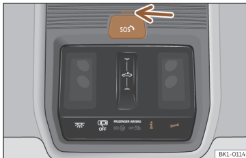
Εικ. 50 Στην κονσόλα της οροφής: χειριστήρια για τις φωνητικές υπηρεσίες.
