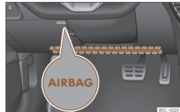
Εικ. 36 Στην πλευρά του οδηγού: θέση του αερόσακου για τα γόνατα.
