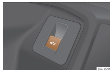
Εικ. 77 Πόρτα οδηγού: μπουτόν για να ανοίξει και να κλείσει το πίσω καπό.
