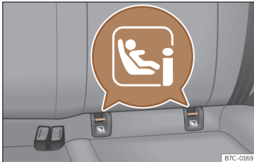
εικ. 35 Πίσω κάθισμα: Δακτύλιοι ασφάλισης ISOFIX ή i-Size.
