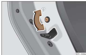
εικ. 66 Κλειδαριά ασφαλείας για τα παιδιά στην πόρτα της αριστερής πλευράς.
