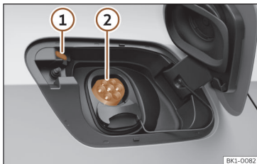
εικ. 48 Πίσω από το κάλυμμα φόρτισης της μπαταρίας στην πίσω δεξιά πλευρά: Πρίζα φόρτισης
