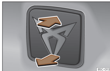
εικ. 67 Πίσω καπό: άνοιγμα από το εξωτερικό.
