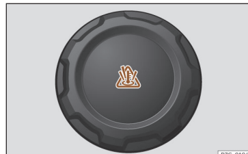
εικ. 158 Μπροστινός χώρος: τάπα δοχείου διαστολής ψυκτικού υγρού.
