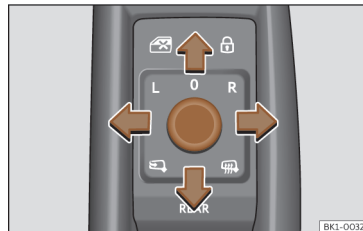
εικ. 88 Λεπτομέρεια της πόρτας του οδηγού: χειριστήριο για τον εξωτερικό καθρέφτη.
