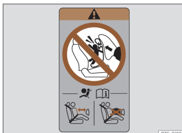
εικ. 34 Αυτοκόλλητο αερόσακου: στο πίσω πλαίσιο της πόρτας της πλευράς του συνοδηγού
