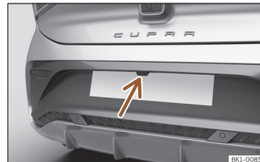
εικ. 100 Στον πίσω προφυλακτήρα: θέση της κάμερας υποβοήθησης της όπισθεν.
