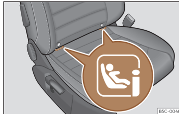
εικ. 36 Κάθισμα συνοδηγού: Δακτύλιοι συγκράτησης i-Size.
