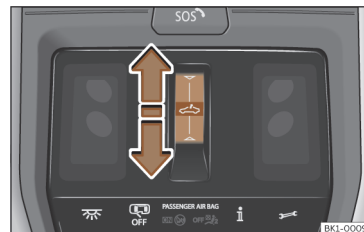
εικ. 90 Στην εσωτερική επένδυση της οροφής: μπουτόν λειτουργίας για τον χειρισμό του σκιαδίου.
