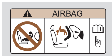
εικ. 33 Αυτοκόλλητο αερόσακου: επάνω στο σικάδιο του συνοδηγού
