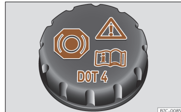
εικ. 159 Μπροστινός χώρος: τάπα δοχείου υγρού φρένων.
